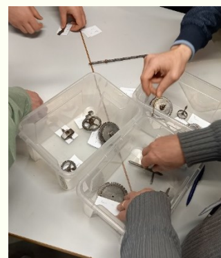
Horloge entièrement démontée avec désignation de chaque composant.
